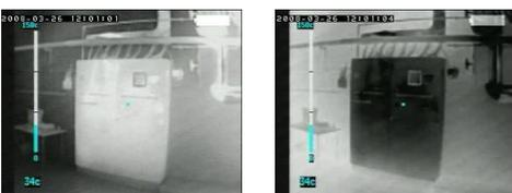
Der **automatische Hitzesucher** zeigt unabhängig von der Temperatur automatisch die relativ heißesten Bereiche in rot. Der **automatische Kältesucher** zeigt unabhängig von der Umgebungstemperatur die relativ kältesten Stellen in blau.
